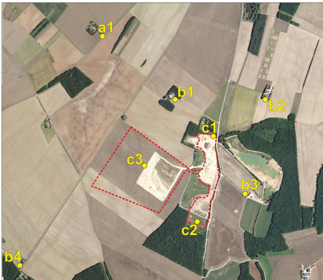
Localisation des stations de mesures selon le plan de surveillance des émissions de poussières en place sur la carrière
